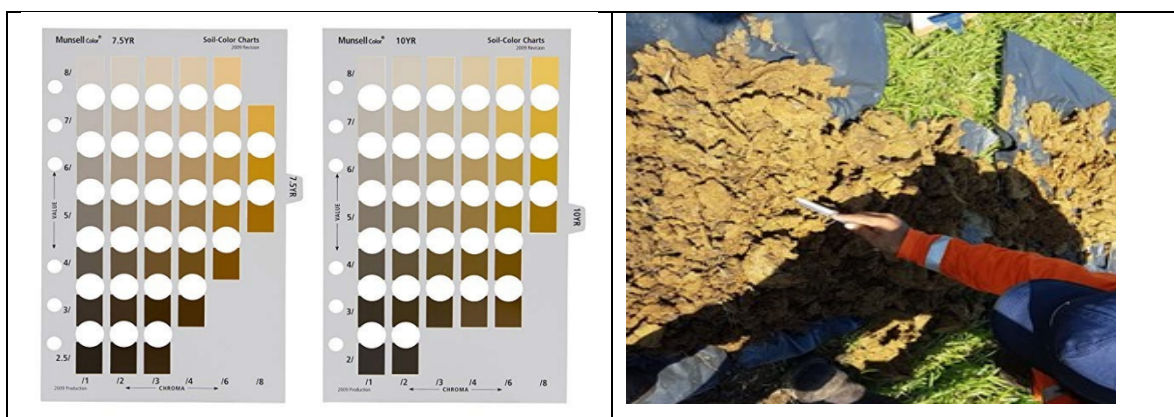
Figura 5. (Izq) Tablas de Munsell para interpretación de color de matriz, moteas y agregados del suelo (Der.) Suelo de municipio de Macuspana, Tabasco.
