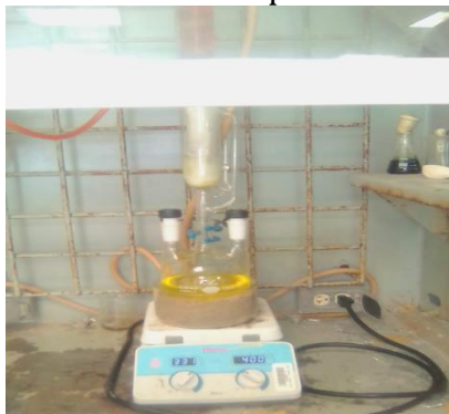
Figura 3. Extracción continua del aceite mediante Soxhlet
