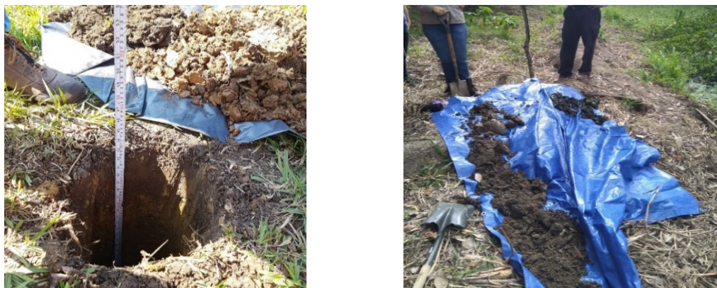
Figura 3. Toma de estrato en punto de muestreo (izq.) y disposición de la muestra para su análisis en campo (der.).
