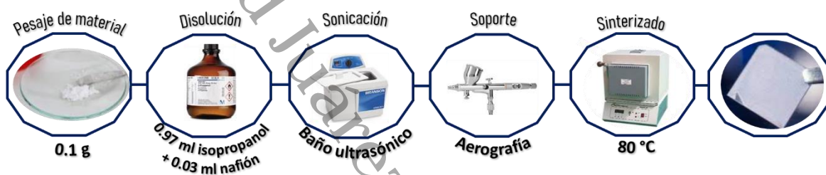
Figura 14. Proceso de elaboración de tintas con las muestras CN, ST Y CN-ST15.
