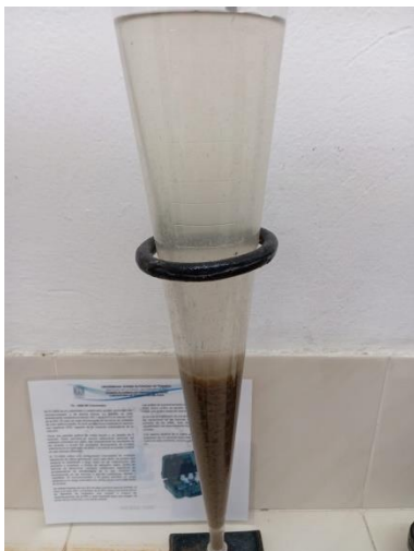
Figura 22. Clarificación del agua residual tratada en el SBR
