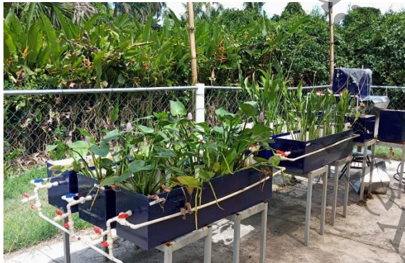
Figura 26. Sistema experimental SBR-Humedales en serie
