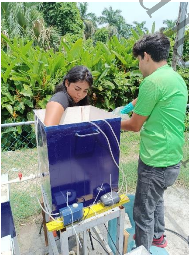
Figura 14. Preparación del lodo bacteriano en el SBR
