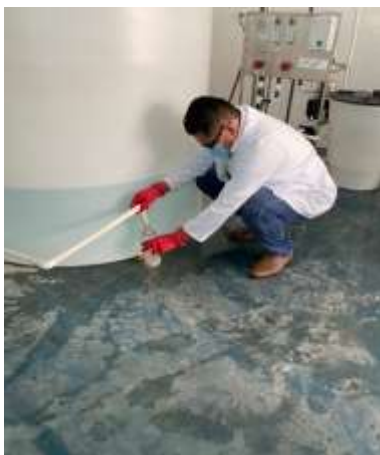
Figura 29. Toma de muestras para el Agua de Rechazo.
