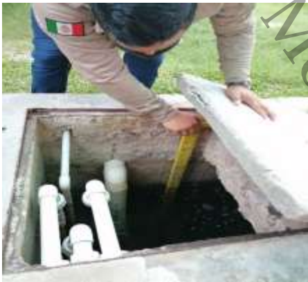
Figura 284. Aforo de Caudal. Fuente: Propia.
