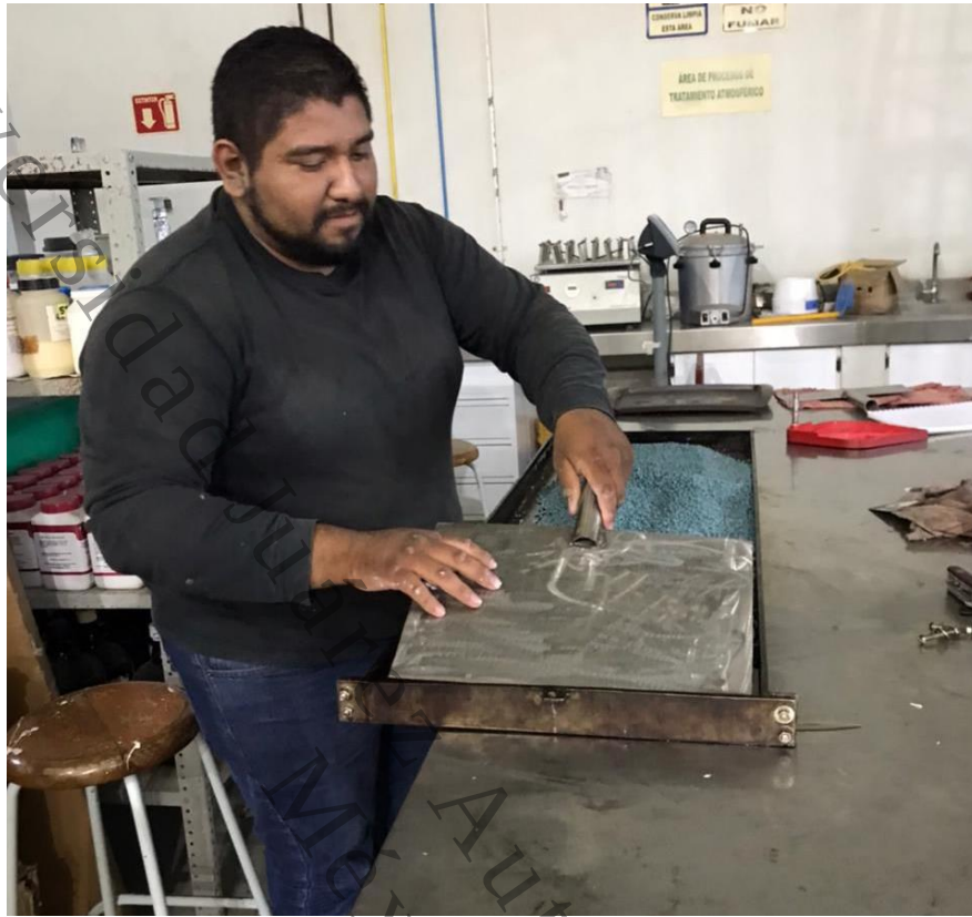
Ilustración 10. Dispersión de polipropileno en molde.
