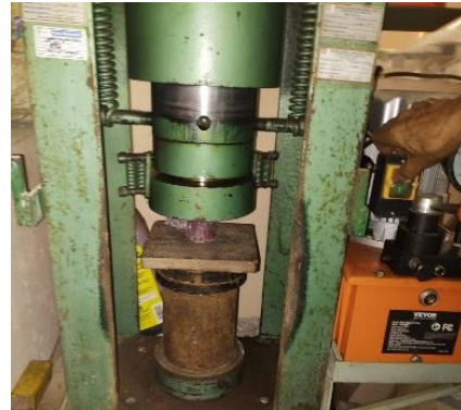
Ilustración 20. proceso de compresión en cilindros de pp.
