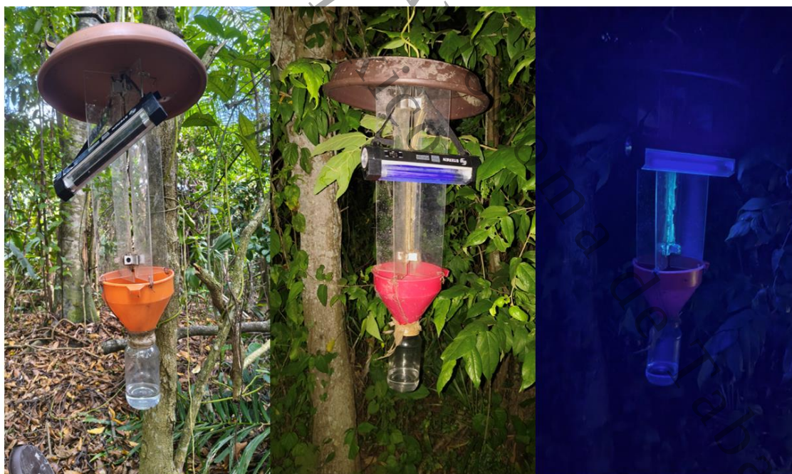
Figura 3. Imágenes de las trampas de luz usadas en campo. a) imagen diurna, b) imagen nocturna y c) imagen nocturna con apreciación de la luz UV.
