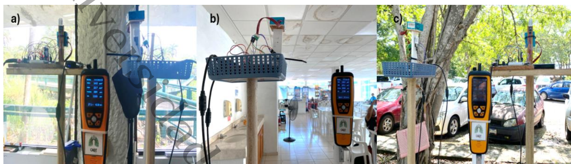
Figura 15. Proceso de calibración del Equipo Emisor-Receptor vs Temtop en a) LCADT, b) Cafetería y c) Estacionamiento
