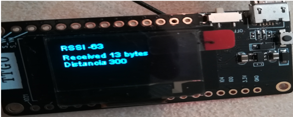
Figura 4.2. Nodo receptor recibiendo datos desde el nodo sensor( Foto de TTGO Lo-Ra32).
