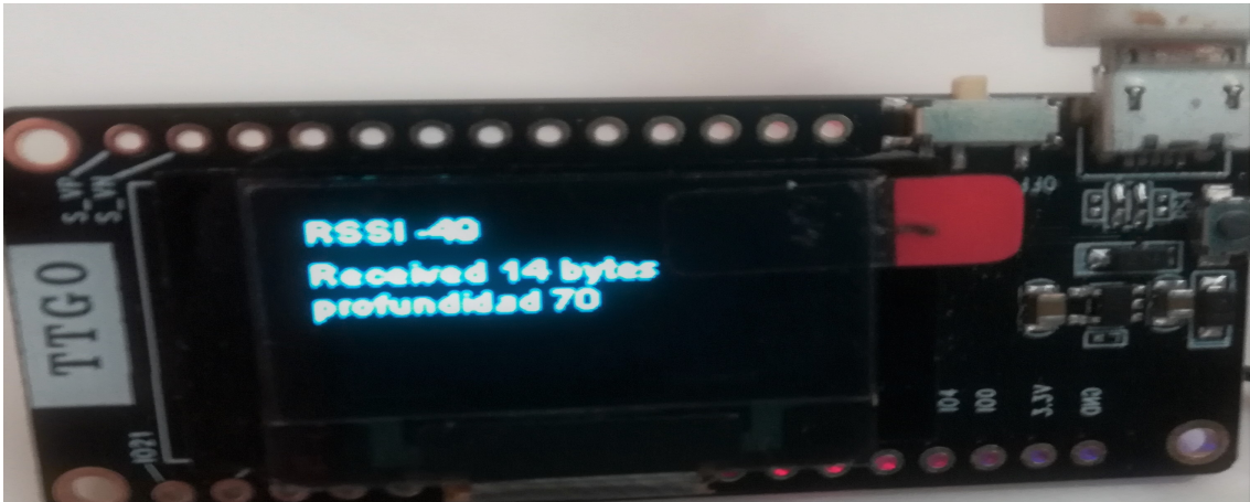
Figura 4.4. Nodo receptor recibiendo datos desde el nodo sensor( Foto de TTGO Lo-Ra32).
