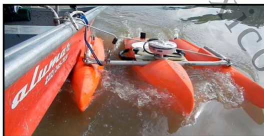
Figura 2. Equipo Doppler RiverRay de 600 kHz.
