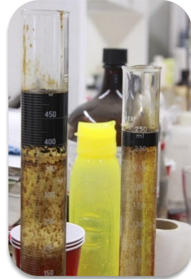
Figura 31. Fase del PC separado del agua congénita
