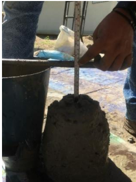
d) Prueba de revenimiento.
