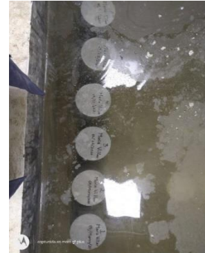
f) Curado de los cilindros.
