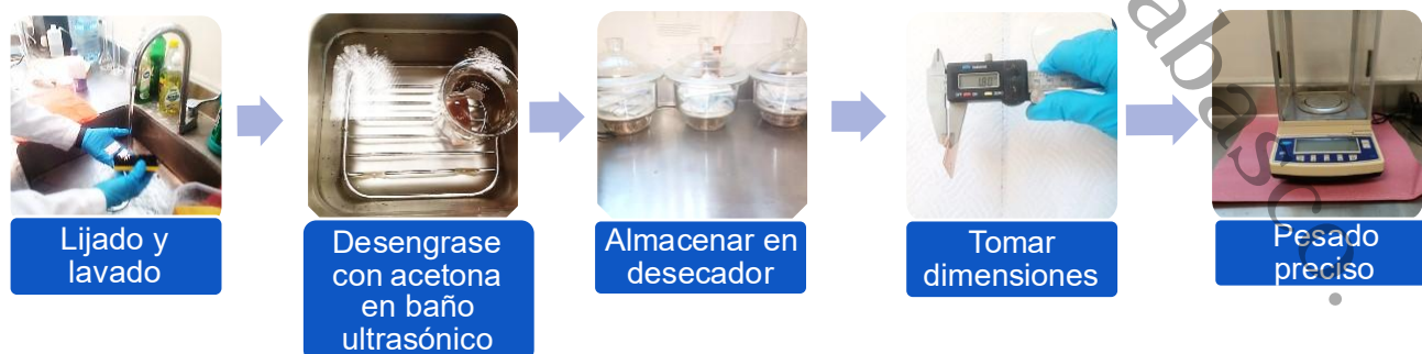
Figura 11 Proceso de preparación de probetas metálicas
