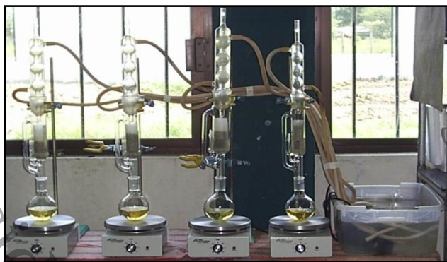
Figura 22. Cuantificación de los hidrocarburos totales del petróleo por extracción Soxhlet EPA.3540
