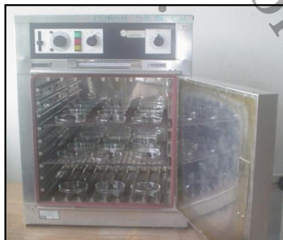
Figura 19. Medición de la humedad
