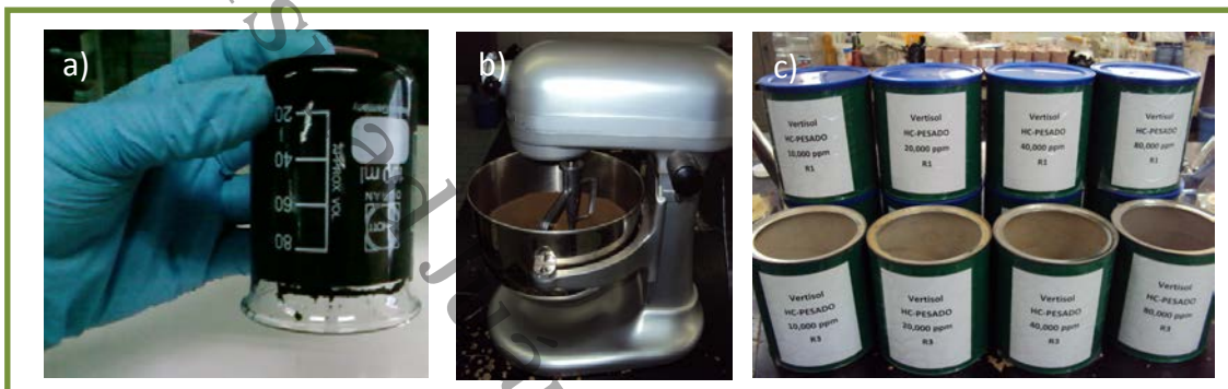
Figura 8. a) Hidrocarburo extrapesado, b) Homogeneización del suelo contaminado con hidrocarburo, c) Unidades experimentales
