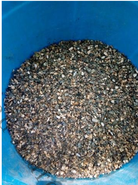
Figura 8. Filtro de gravilla de revestimiento
