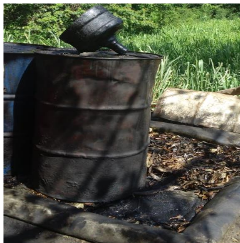
Figura 21 Contenedor de 200 litros totalmente impregnado de aceite lubricante usado y oxidado, sobre una membrana en malas condiciones, situado al final del taller mecánico a las orillas del río carrizal.
