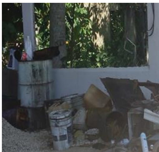
Figura 22 Contenedor de 200 litros sin etiqueta, sobre el piso de arena, junto a los residuos del metal provenientes del mismo taller. En el mismo taller se encontraron bidones vacíos de aceite y cubetas impregnadas de pintura en inadecuado almacenamiento
