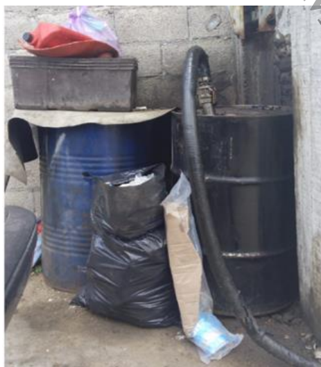
Figura 26 Residuos peligrosos junto con residuos sólidos urbanos
