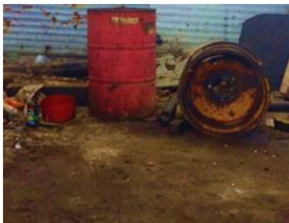
Figura 25 Contenedor de 200 litros rumbrado, manchado y sin etiqueta, suelo totalmente impregnado por el mismo residuo. Así mismo envases con residuos peligrosos sobre el suelo.
