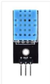
El sensor de temperatura y humedad relativa del aire DHT11 es un dispositivo de fácil adquisición y de bajo costo aproximadamente de unos \$100.00 MXN. Este sensor se utilizo para medir en interiores y exteriores.
