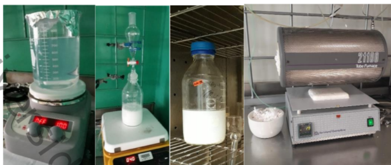
Figura 18. Procedimiento de síntesis del óxido de bismuto por el método hidrotérmico.
