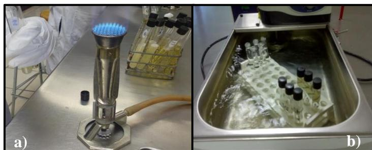
**Figura 6. a)** Prueba confirmativa para la búsqueda de CF, resiembra de tubo positivo (+) de CT Caldo Lauril Sulfato de Sodio (LSS), a medio de enriquecimiento EC. **b)** Incubación de los tubos en el baño de agua (baño maría) a  $44.5 \pm 0.5$  °C, durante un periodo de  $24 \pm 2$  h.
