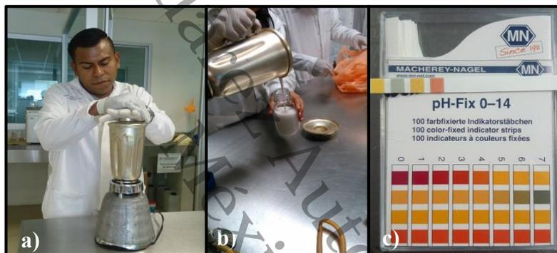
**Figura 7.** a) Homogenización del tejido blando y líquido intervalvar, en medio de pre-enriquecimiento caldo lactosado. b) Transferencia del homogenizado al frasco con tapón. c) Tiras de pH.
