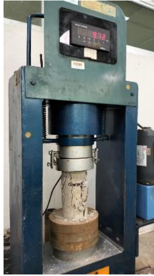
Figura 7. 81 Muestra de concreto con la carga axial aplicada
