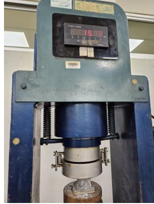
Figura 7. 74 Carga axial soportada por la muestra de pasta
