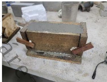
Figura 7. 60 Muestra de barra de mortero
