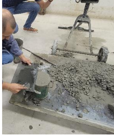
Figura 7. 67 Enrasado del cono con mezcla de concreto
