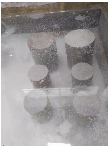
Figura 7. 71 Muestras cilíndricas de concreto en la pileta para su curado
