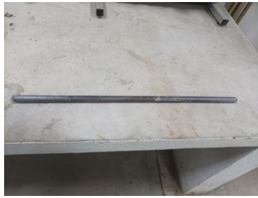
Figura 7. 32 Varilla de apisonamiento
