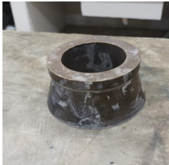
Figura 7. 11 Cono metálico (para fluidez en pasta y mortero)
