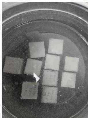
Figura 7. 53 Muestras de pasta (agua-cemento) saturadas
