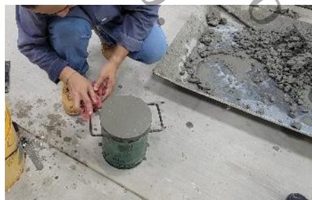
Figura 7. 70 Limpieza de la muestra de concreto
