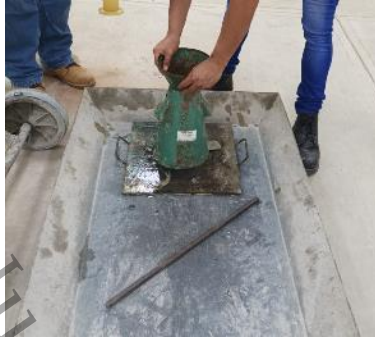
Figura 7. 65 Equipo para obtener el revenimiento
