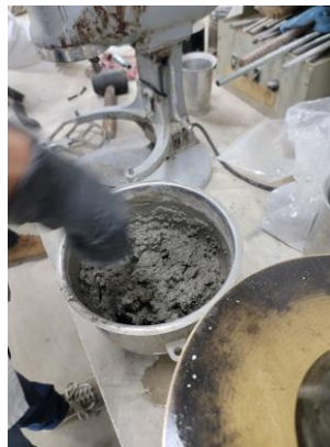
Figura 7. 75 Mezcla de mortero
