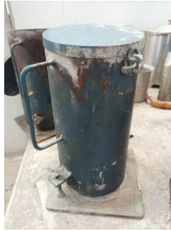
Figura 7. 26 Molde metálico (para muestras cilíndricas de concreto)
