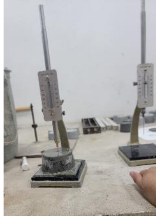
Figura 7. 48 Lectura de la primera penetración en la prueba de tiempo de fraguado
