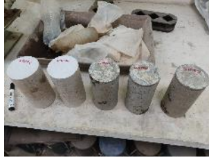
Figura 7. 79 Muestras de concreto para ensayo de resistencia
