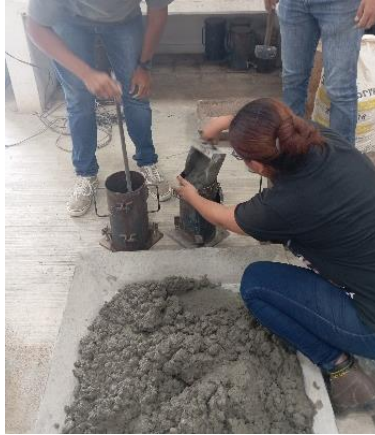
Figura 7. 69 Llenado de los cilindros con mezcla de concreto con el número de golpes
