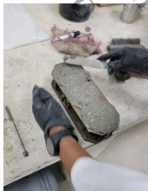
Figura 7. 52 Enrasado de las muestras cúbicas
