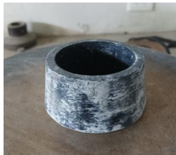
Figura 7. 13 Cono de plástico (para tiempo de fraguado)
