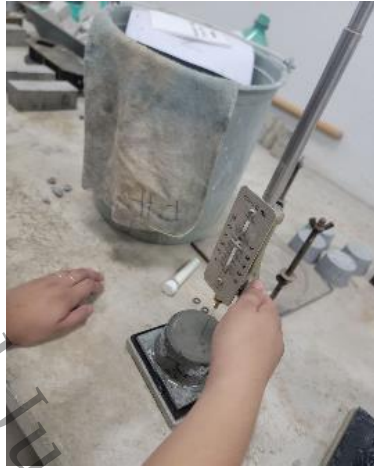
Figura 7. 41 Ensayo de Vicat después del moldeo de la mezcla
