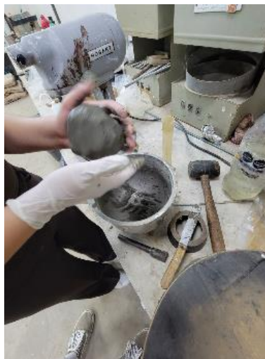
Figura 7. 40 Moldeo de mezcla para el cono de plástico
