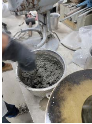
Figura 7. 44 Pasta final para la prueba de fluidez
