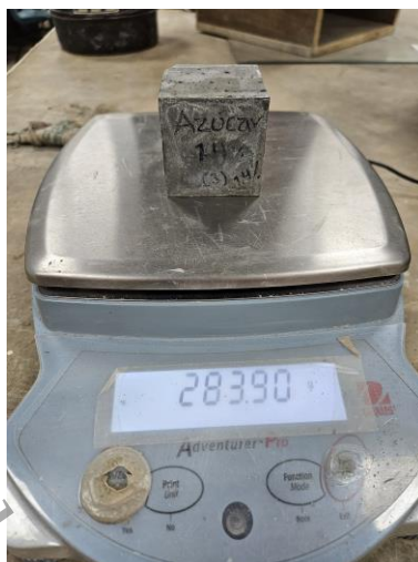
Figura 7. 55 Peso de la muestra después de la SSS
