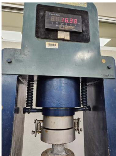
Figura 7. 78 Carga axial soportada por la muestra de mortero
