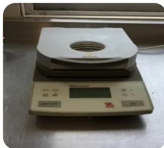
Figura 14. Medición de la humedad de la biomezcla.
