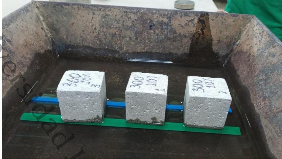
*Imagen 4.21 Absorción por capilaridad en muestras de mortero con sustitución parcial del 10% por conchas de ostión calcinadas a 300 grados Celsius.*
