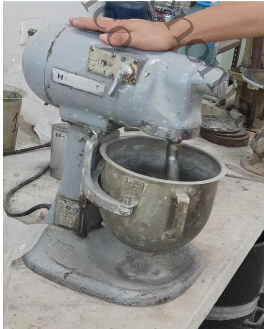
*Imagen 3.31 Mezcladora automática para mortero*
