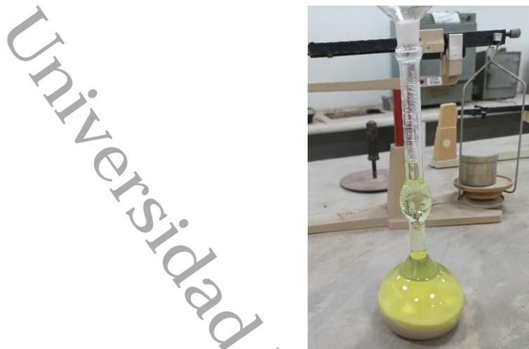
*Imagen 2.4 medición de la densidad del cemento*
