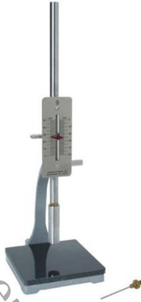
Imagen 3.32 Aparato de Vicat (Aparato de Consistencia Vicat - BSmart, n.d.)
