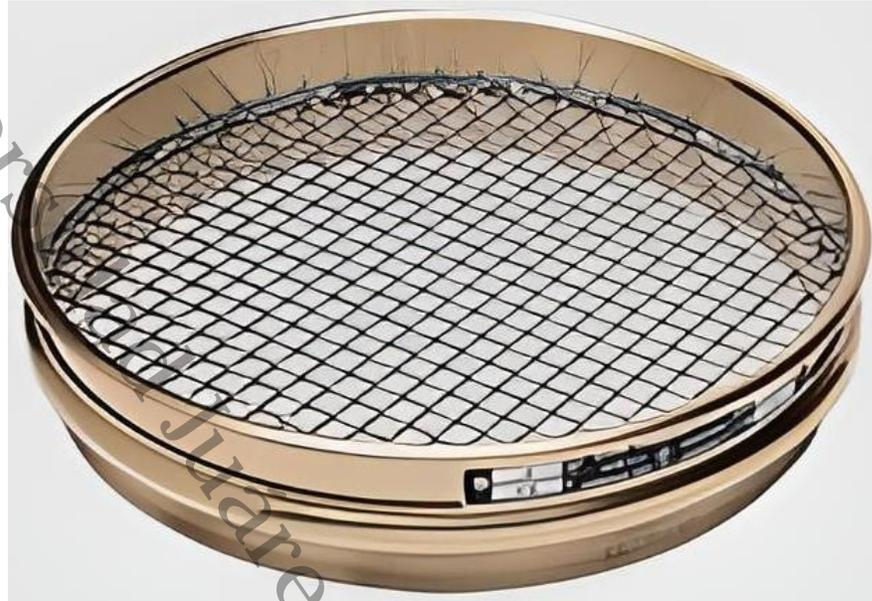
*Imagen 3.20 Tamiz No. 4 (Tamiz Estándar De 8", De Diámetro, No 4 (4.75 Mm) De Malla Inoxidable Con Marco De Latón Y 2" (50 Mm) Completas De Profundidad » COTECNO | Equipamiento Científico | Prospecciones, Auscultación, Geofísica, Ingeniería, n.d.).*
