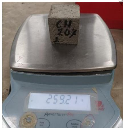
Imagen 4.19 Peso saturado en muestra de mortero con sustitución parcial del 20% por conchas de ostión calcinadas a 150 grados Celsius.
