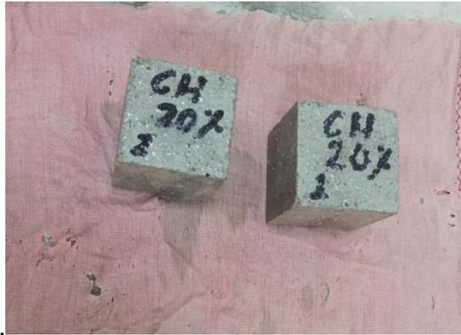
Imagen 4.18 Triple S en muestras de mortero con sustitución parcial del 20% de conchas de ostión calcinadas a 150 grados Celsius.
