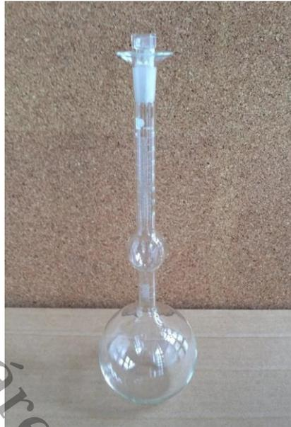
*Imagen 3.18 Matraz Le Chatelier (Probeta De Vidrio Para Gravedad Específica - Le Chatelier | MercadoLibre, n.d.)*
