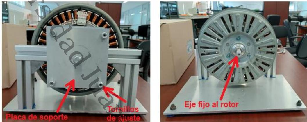
Figura 31. Placa de soporte y eje del motor.
