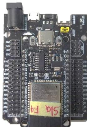
Figura 1.4 ESP32 DOIT DEKIT
