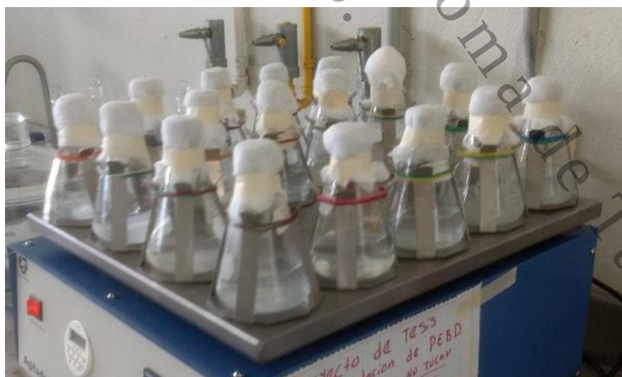
Figura 8. Fase de adaptación en medio de sales minerales con 300 mg de PEBD.
