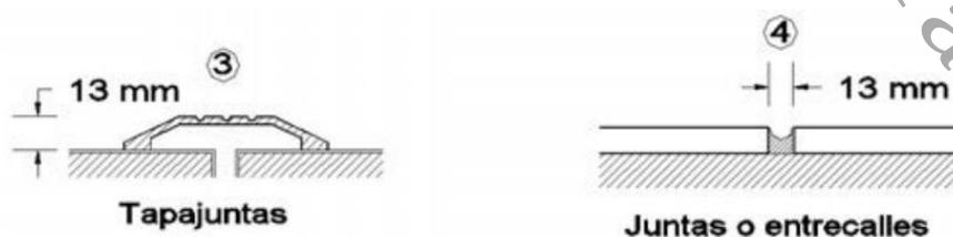
Figura 52 Detalle de tapajuntas, y juntas o entrecalles. [Figura]. Fuente: (Manual de Normas Técnicas de Accesibilidad, 2016)
