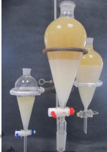
Figura 24. Separación de fases, recuperación del precipitado.
