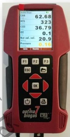
Figura 18.- Analizador de gas de Combustión OPTIMA BIOGAS 7.
