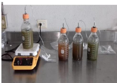
Figura 31. Agitación de los reactores.
