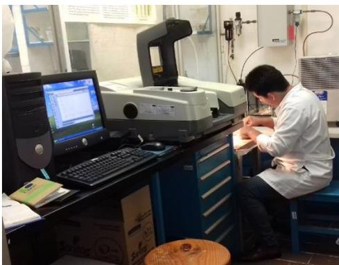
Figura 37. Acondicionamiento del tratamiento de la muestra para leerse por FTIR.
