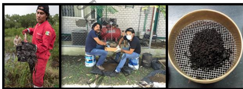
Figura 12. Recolección y tamizado de Suelo Intemperizado contaminado con hidrocarburos
