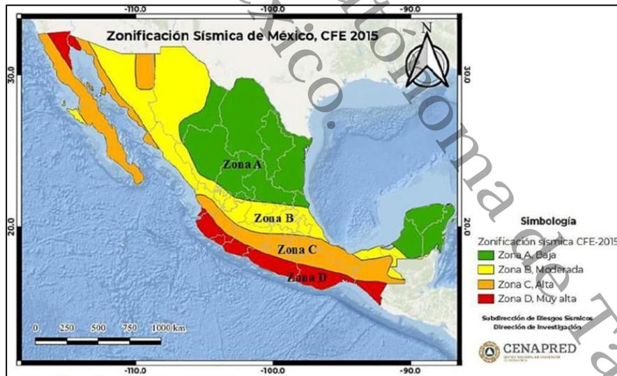
Figura 2. Zonificación sísmica de México de acuerdo a CFE (2015), estando Tabasco en zona B y zona C.
