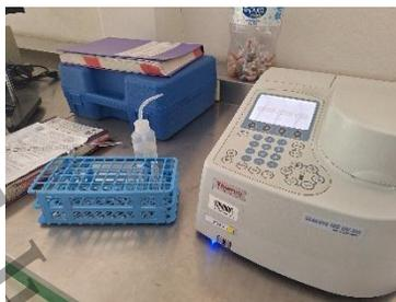
Figura. 27. Uso del Espectrofotómetro UV-VIS
