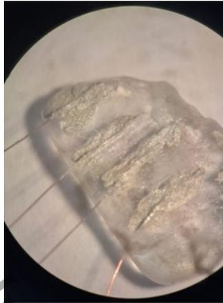
Figura 2.16: Electrodo adheridos a un cristal de NaCl puro, visto desde un microscopio a 10x.
