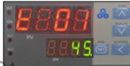
Figura C.2: Código para cambiar el tiempo en que subirá la temperatura hasta la siguiente temperatura.
