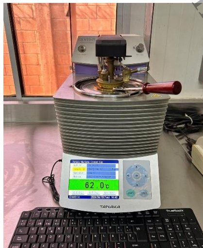
Figura 27. Análisis de flash point finalizado, imagen propia AMSPEC DB.
