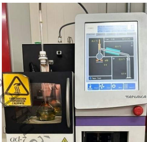
Figura 22. Muestra colocada en el destilador, imagen propia AMSPEC DB.
