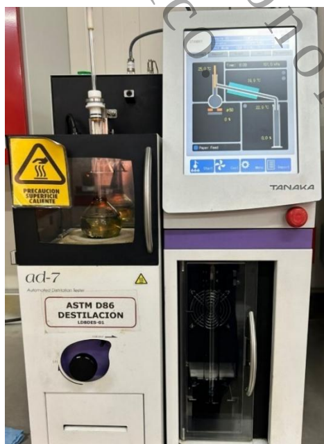
Figura 19. Destilador AP-7, TANAKA, Imagen propia AMSPEC DB.
