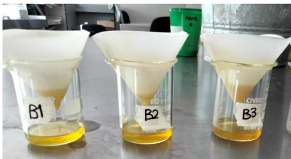
**Figura 9 Procedimiento de filtrado para prueba de pH y CE**
