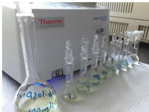
Figura 5 Soluciones de  $10 \text{ mgL}^{-1}$  de solución madre de FZD grado HPLC
