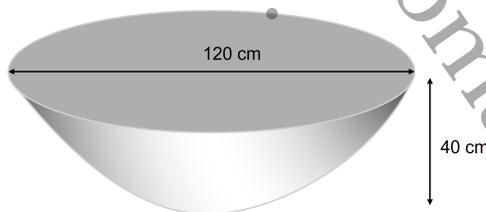
Figura 7.14: Horno solar con medidas.
