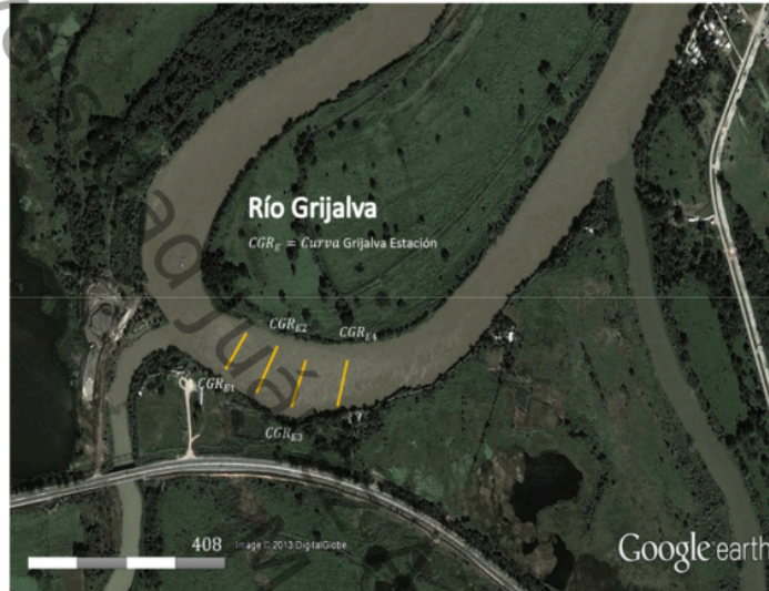
Figura 4.3. Estaciones de medición en una curva escogida aguas abajo de la confluencia Grijalva - Carrizal.
