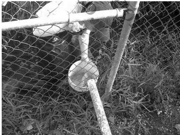
Figura 7. Aforo de descarga de agua tratada de la PTAR de la DACBiol.
