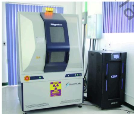
Figura 34. Difractor Rigaku empleado para la caracterización estructural.
