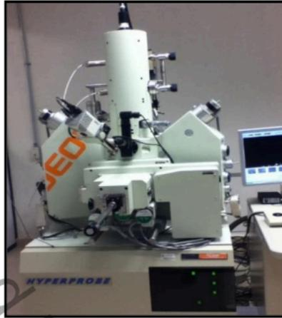
Figura 22. Microscopio electrónico de barrido
