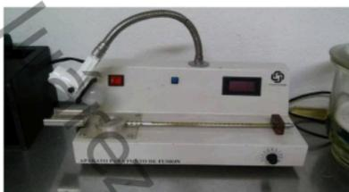
Figura 5. Equipo Fisher-Jones para puntos de fusión.
