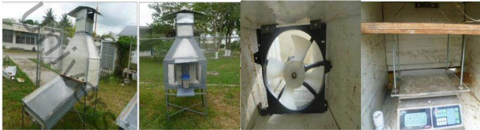
Figura 4.18. Secador solar construido
