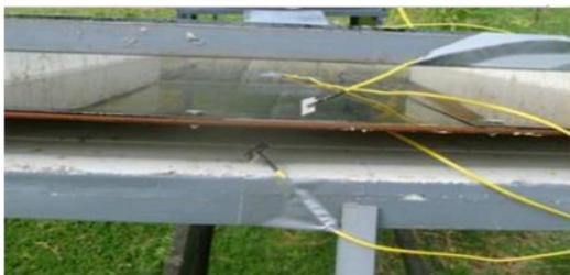
Figura 4.16. Colector solar de placa absorbadora plana con recubrimiento selectivo
