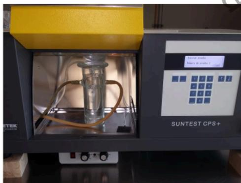
Figura 15. Sistema de reacción, equipo SUNTEST CPS+.
