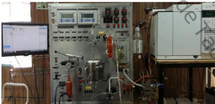
Figura 3.3 Reactor de flujo continuo y sistema de cromatografía de gases del CNyN.
