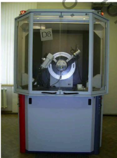
Figura 1.6. Difractómetro de Rayos X D8 Advance de Bruker
