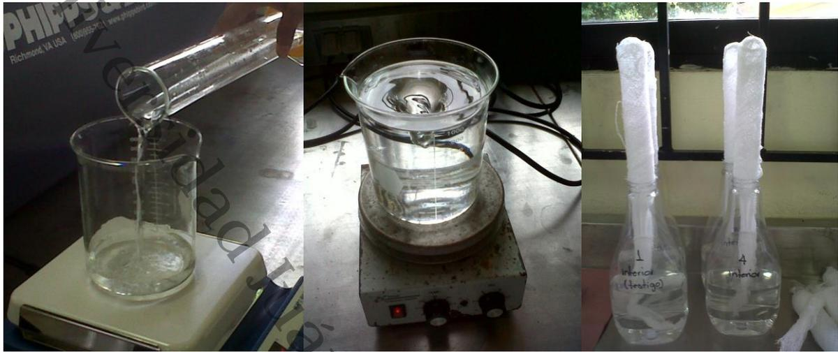
**Figura 17.** Secuencia de preparación de captadores de Cl<sup>-</sup>.
