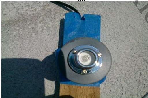
93.- Piranometro colocado a la microestacion para medir radicacion.
