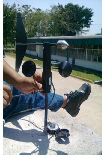
96.- Colocacion de veleta y sensor para medir velocidad y direccion del viento direccionado a la microestacion
