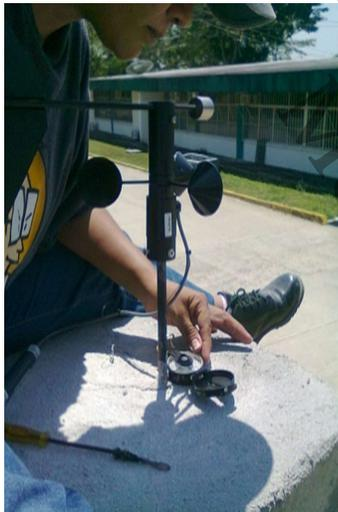
97.- Orientacion de la veleta para medir velocidad y direccion el viento (hacia el norte, señala el manual)
