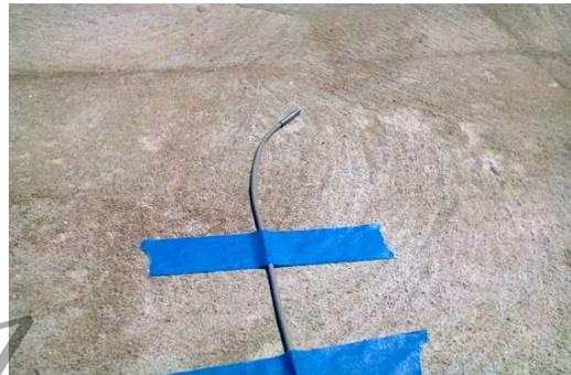
92.- Sensor para medir emperatura de la superficie interior y exterior, colocado al equipo data logger.
