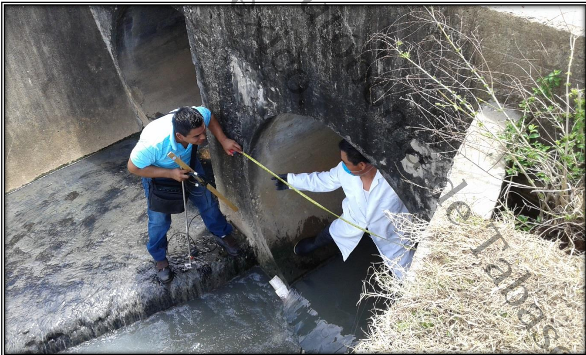
Fotografía 4. Caracterización de caudal en la descarga puntual y medición del canal
