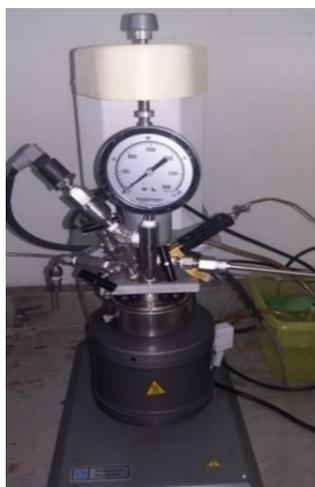
Figura 8. Reactor Batch de acero inoxidable de 600 mL
