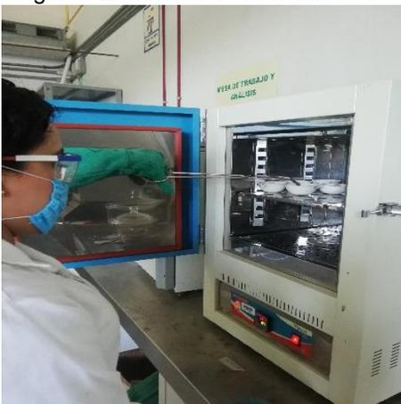
Figura A22 análisis de muestras para determinación de SST
